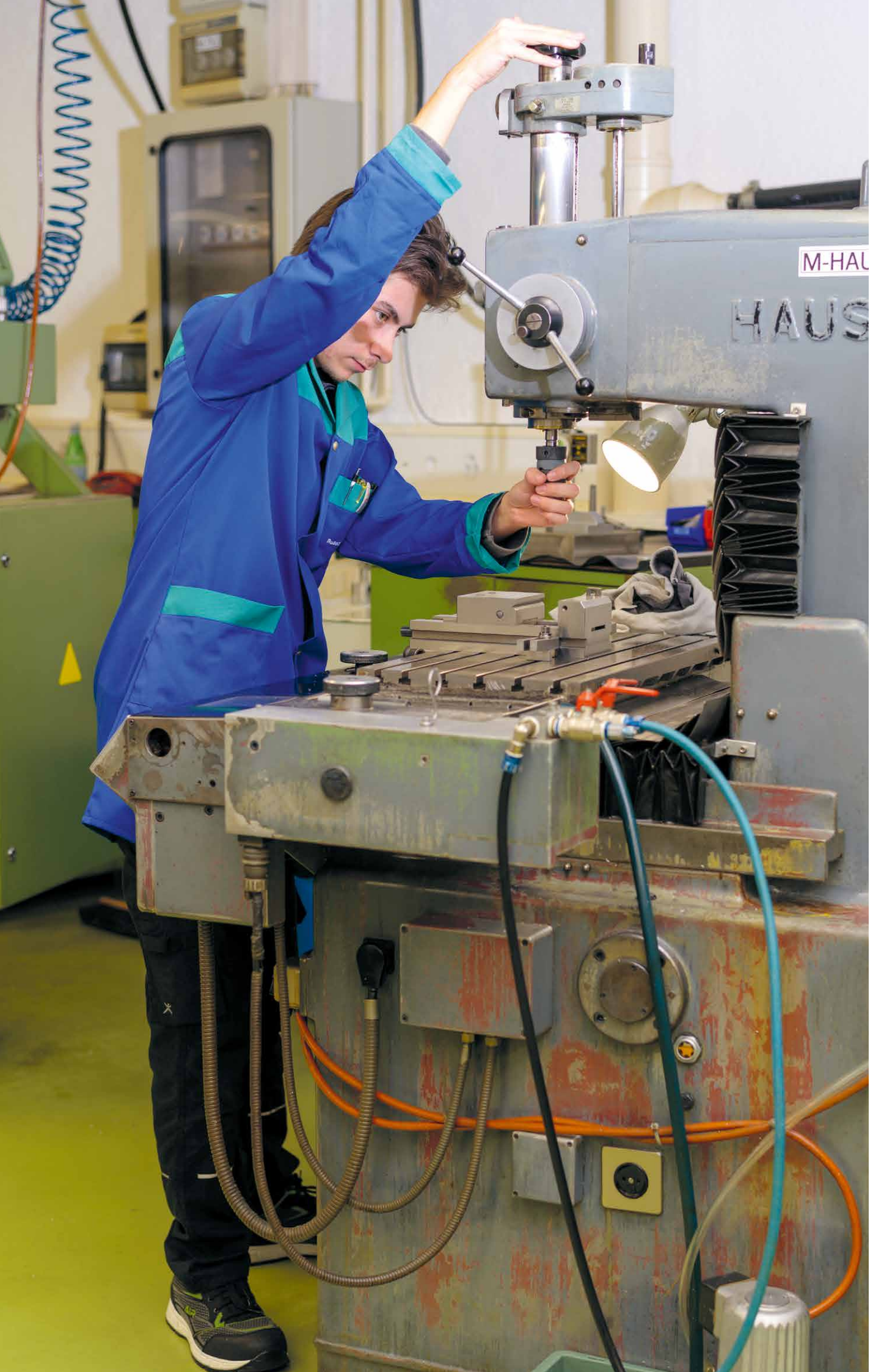
Leandro Fresta remplace le foret sur la perceuse.
